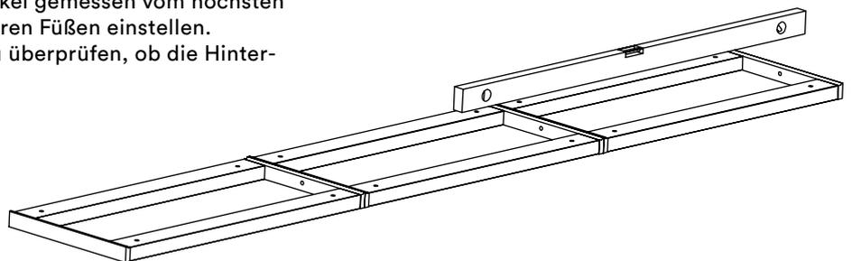
4. Anschließend die Vorderkante der Sockel mittels verstellbarer Füße und Wasserwaage in gleicher Weise nivellieren, sodass sowohl die Tiefe als auch die Länge vollkommen eben sind.
