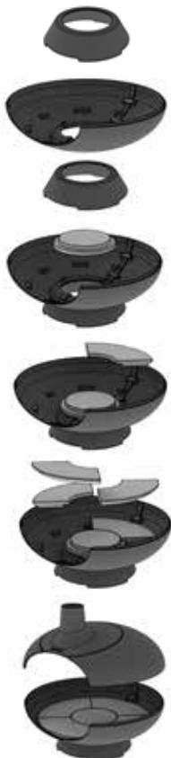
1. Placér soklen på en plan overflade, helst der hvor du ønsker, at ovnen skal stå.
