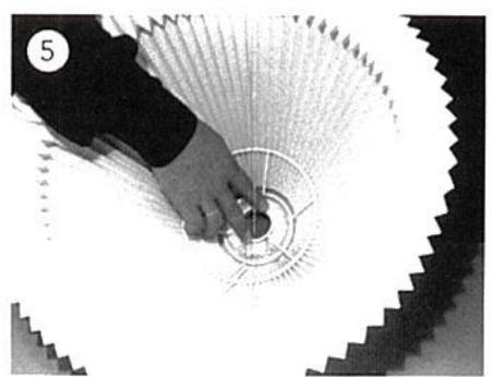
Grebet omkring kraven løsnes, til gribekraven med huller sidder fast på stativet.
